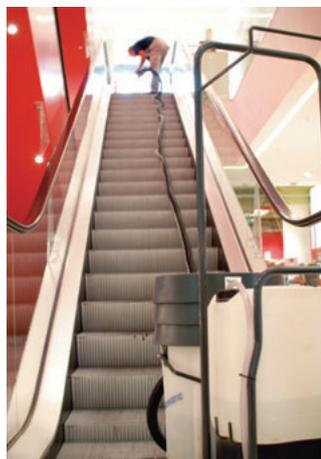
Im Basement schnurrt die Gregomatic 300, der 30-Liter Frischwassertank ist gefüllt, der 30-Liter Schmutzwassertank leer, der 10 Meter lange Schlauch liegt auf der Rolltreppe
