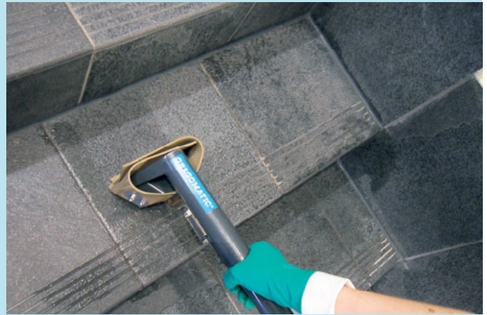
Treppenreinigung ohne chemische Vorbehandlung.
