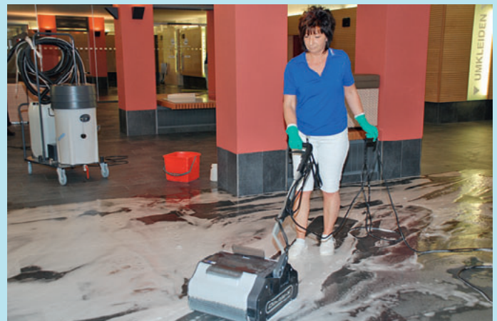
In den Umkleidebereichen kommt ein Vakuum-Waschautomat (hinten) zum Einsatz. Zuvor reinigt Vorarbeiterin Sigrid Viertl die dunklen Feinsteinzeugfliesen mit einer kontrarotierenden Bürstenwalzenmaschine.
