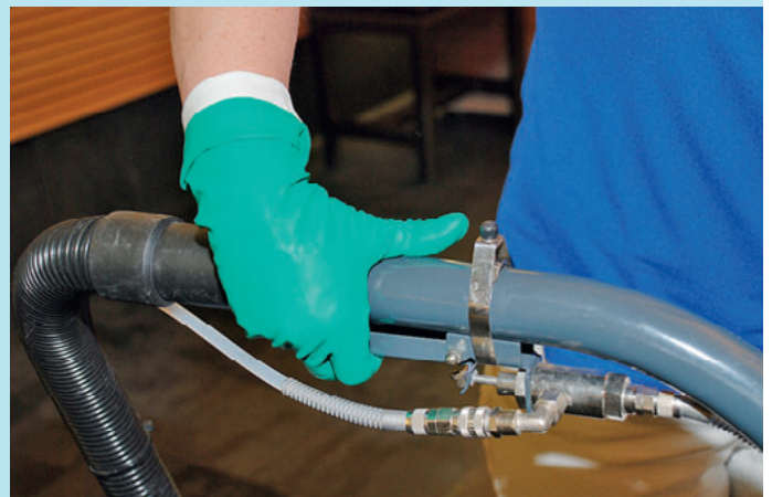
Wenn die Reinigungskraft den Hebel am Handrohr des Waschautomaten zieht, sprüht klares Wasser durch die Sprühköpfe der Spül- und Saugdüse auf die zu reinigende Fläche.
