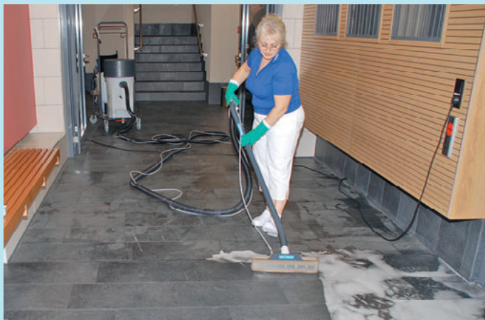
Der Waschautomat arbeitet mit Wasser, das auf den Boden gesprüht und durch Unterdruck verwirbelt wird. Schmutz und – eventuell verwendete – Reinigungschemie werden anschließend aufgesaugt.
